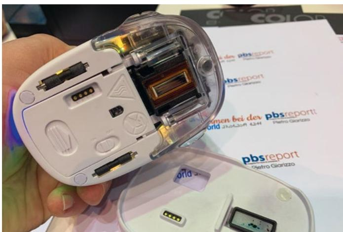
Der „e-mark“ ist gleichzeitig auch der kleinste Tintenstrahldrucker.
