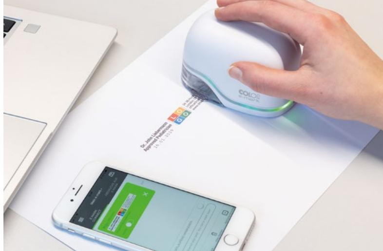
Ein einzelner Abdruck kann bis zu 150 Millimeter lang sein. Mit einer Spezialfunktion lässt sich dieser aber mit nur einer Seitwärtsbewegung beliebig oft wiederholen.
