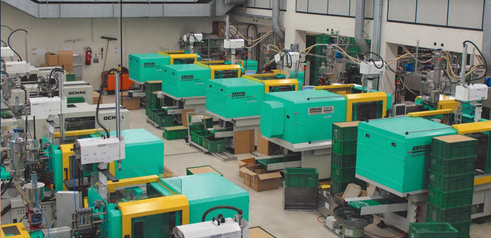
Die eingesetzten Recycling-Kunststoffe (links) werden von einem unabhängigen Institut auf den Recyclatgehalt geprüft und zertifiziert. Die daraus gefertigten Produkte dürfen gemäß der Norm DIN EN ISO 14021 als Recyclingprodukte bezeichnet werden. In der Kunststofffertigung (oben) werden die Kunststoffteile für die einzelnen Modelle gespritzt. Dabei weisen die biobasierte Kunststoffe dieselben Eigenschaften wie herkömmliche Kunststoffe auf.
