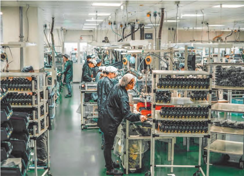
In einem Reinraum werden die Tonerkartuschen geprüft und befüllt. Brother setzt an einigen Stationen inzwischen auch Industrieroboter ein.
