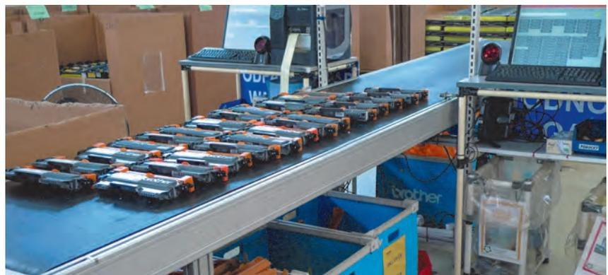
Die verbrauchten Tonerkartuschen werden nach Eingang einer strengen Kontrolle unterzogen. Wiederverwertbares Material geht dann in den Produktionsprozess.
