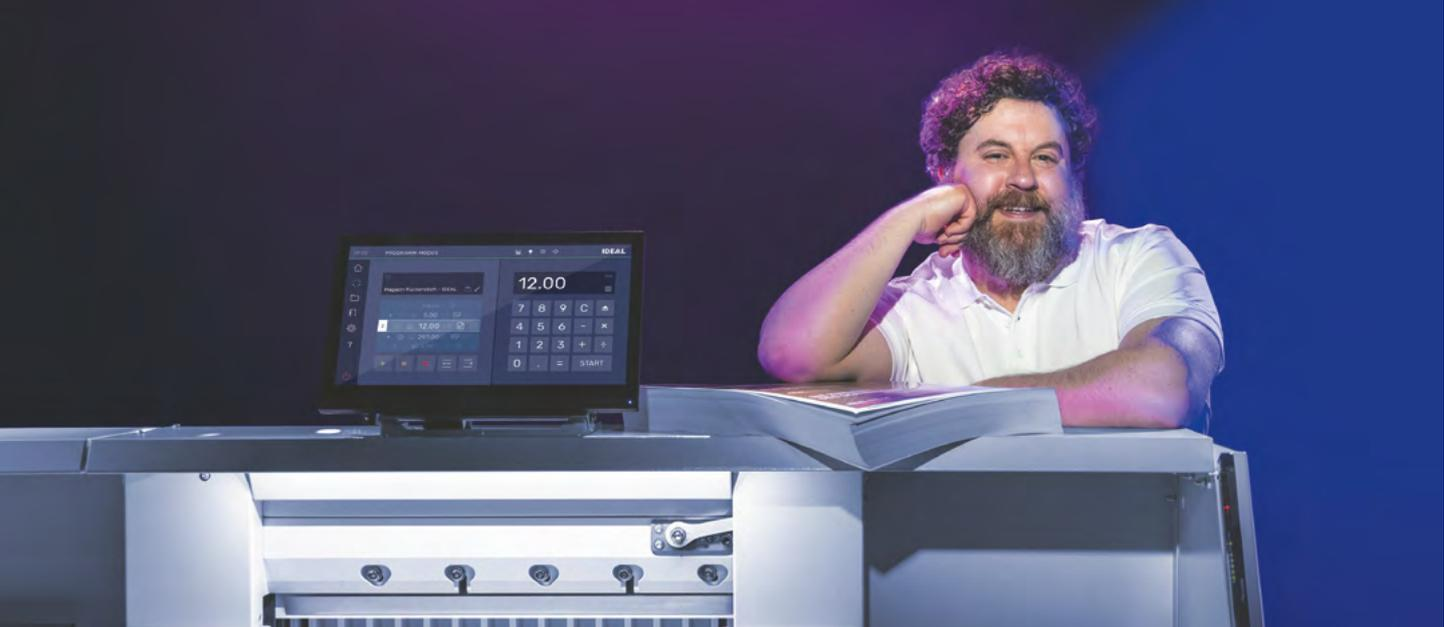
Schnittlänge: 560 mm, Schnitthöhe: 80 mm, Restschnitt: <15 mm, Einlegetiefe: 560 mm - so lauten die Grund-Spezifikationen von „THE 56“. Dieser Stapelschneider erleichtert damit das Arbeiten bei anspruchsvollen und umfangreichen Projekten. Das Resultat sind ein optimaler Workflow und makellose Präzision.
