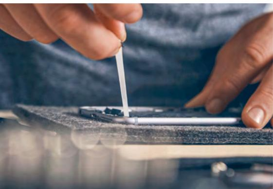
Mit innovativen Klebestreifen lässt sich die Batterie im Mobiltelefon sicher fixieren und rückstandsfrei wieder entfernen.
